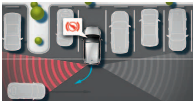
Der Ausparkassistent warnt den Fahrer vor Verkehr, der für ihn möglicherweise nicht zu sehen ist. Wenn der Fahrer darauf nicht reagiert, kann das System einen Notbremseingriff durchführen.
